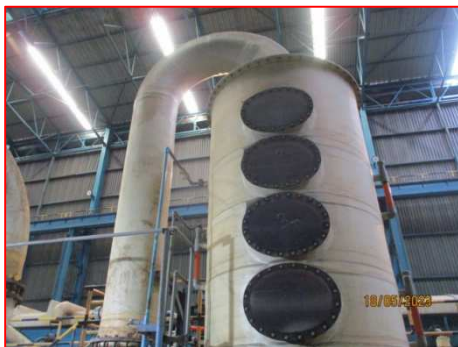
ภาพที่ 2-4 Scrubber ที่หน่วย Pickling Oil Plant
