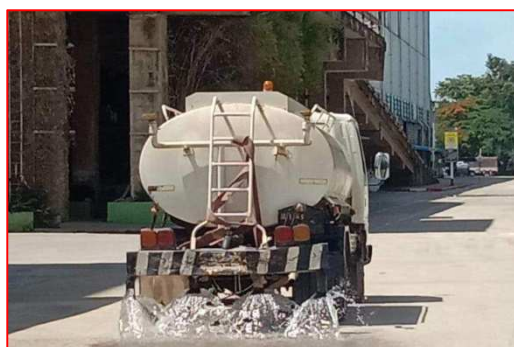
ภาพที่ 2-16 การนำน้ำทิ้งภายหลัง การบำบัดมาฉีดล้างถนนภายในโครงการ
